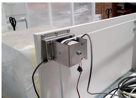
Montage en substitution d'un renvoi d'angle
